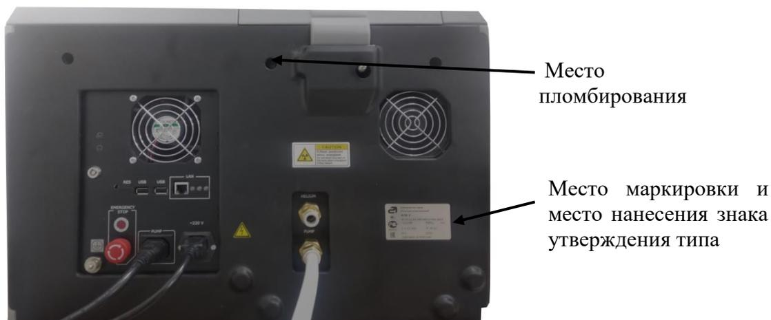
Рисунок 2а – Место пломбировки, место маркировки и место нанесения знака утверждения типа на задней панели блока аналитического анализатора
