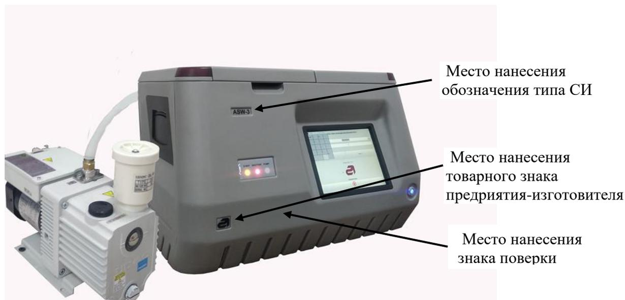
Рисунок 1 – Общий вид анализаторов серы рентгеновских воднодисперсионных АСВ-3
