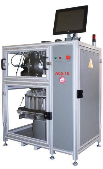
Автомат сортировки алмазов по форме ACA-1K предназначена для автоматической классификации алмазного сырья по качеству и сортировки кристаллов или фрагментов на 12 групп.
