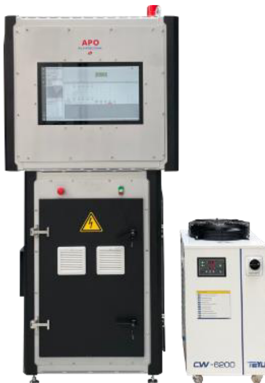
Рисунок 1 – Общий вид анализаторов рентгеновских однокюветных АРО
