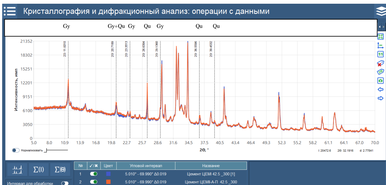
Рисунок А-2 – Сравнение рентгенограмм образцов цемента. Основная разница наблюдается в интенсивностях рефлексов гипса (Gy) и кварца (Qu).
