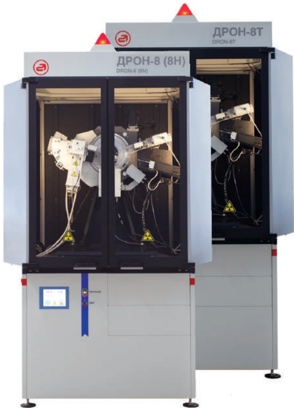
Конструкция дифрактометров обеспечивает полную защиту обслуживающего персонала от рентгеновского излучения.
