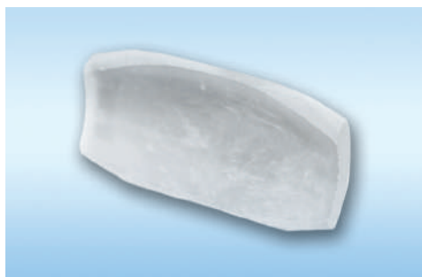
Монохроматор тороидальный. R1=150 , R2=75 , \text{LiF}(200) , 2d=0.403 нм
