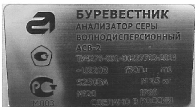
Рисунок 3 – Вид фирменной таблички с заводским номером анализаторов серы волнодисперсионных АСВ-2
