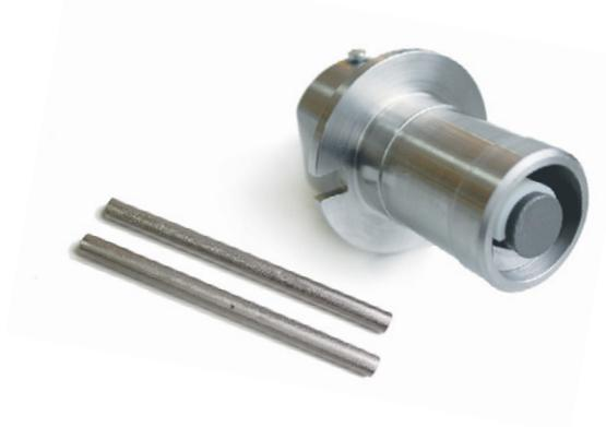
в. чашки для установки небольших лопаток (Ø до 28 мм);
