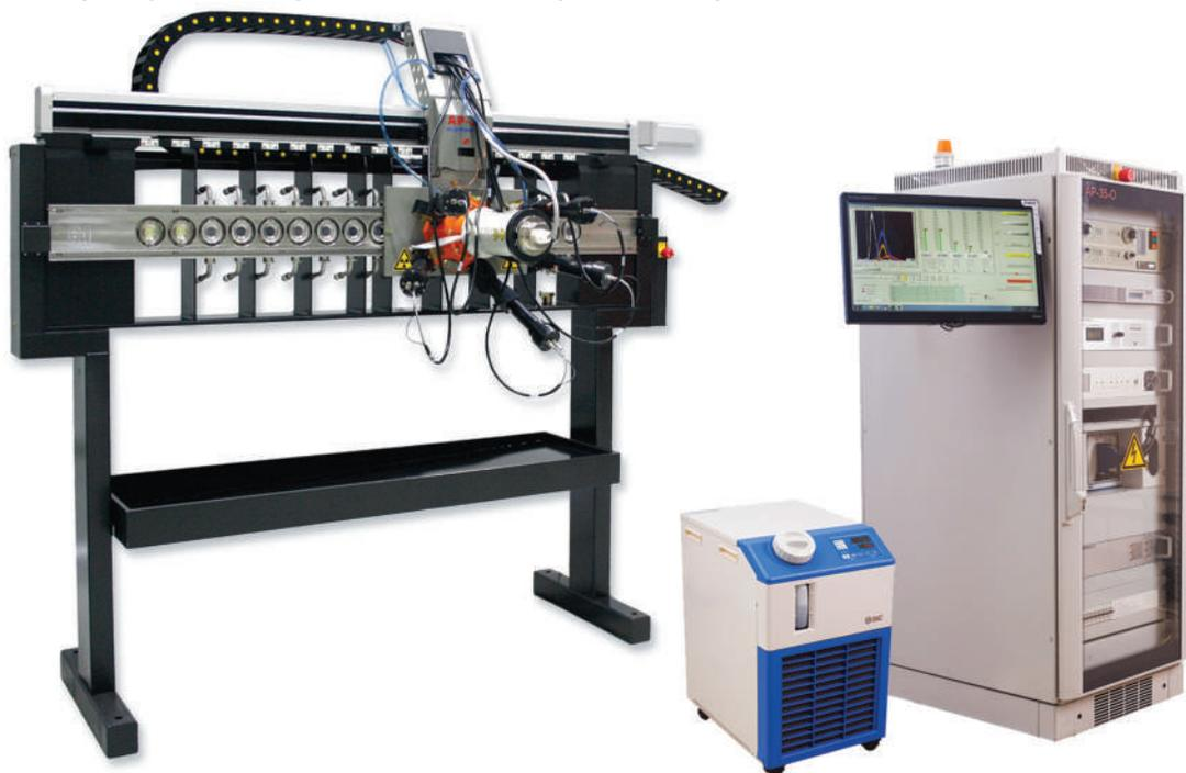
Анализатор AP-35 предназначен для непрерывного рентгенофлуоресцентного анализа химического состава пульп, суспензий, растворов в потоке и определения массовой доли химических элементов от серы S до урана U. Прибор имеет до 15 проточных кювет для продуктов, передвижную программно-управляемую измерительную головку с рентгеновской трубкой и фиксированными спектрометрическими каналами и/или приставкой с полупроводниковым детектором.
