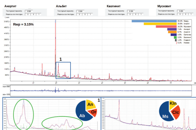
Рис. 7. Пример количественного анализа методом Ритвельда образца золотосодержащей горной породы с учетом преимущественной ориентации частиц в слоистых и каркасных алюмосиликатах: 1 – идентификация структурной разновидности полевых шпатов [ортотлаз (Or)] и проявление изоморфизма у плагиоклаза [альбит (Ab) + анортит (An)]; 2 – количественный анализ методом Ритвельда глинистой фракции, выделенной из данного образца (Ms – мусковит, Clc – клинохлор, Kln – каолинит)
