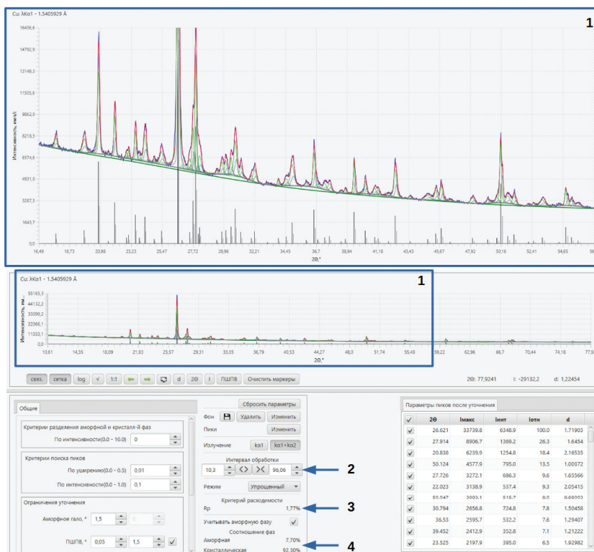
Рис. 1. Пример предварительной обработки дифрактограммы продукта обогащения золоторудного месторождения (в рамках работы по контролю технологических процессов обогащения):
