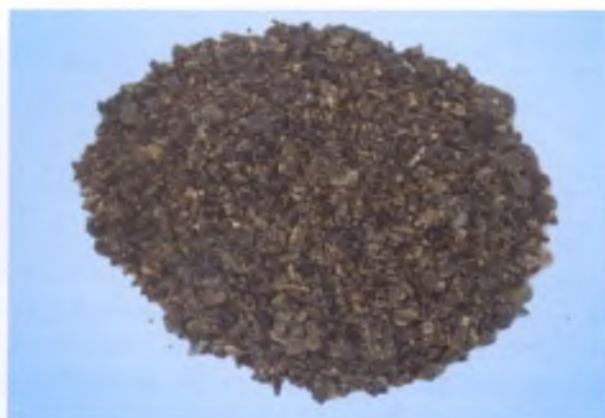
Солеотложения месторождения XXXX, преобладают карбонатные соединения и соединения железа
