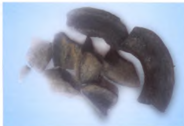
Солеотложения с месторождения XX, преобладает сульфат бария
