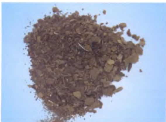
Солеотложения месторождения XXX, преобладают карбонатные соединения
