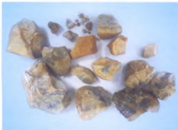
Солеотложения с месторождения X, преобладают карбонатные соединения и соединения железа
