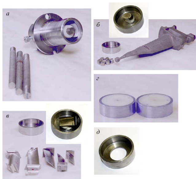
Рис. 8. Держатели, входящие в комплект принадлежностей приставки ПГТМ: а — держатель стержней; б, в — чашки для небольших изометричных образцов ( \varnothing до 28 мм); г — центрирующий держатель для монокристаллов малого размера ( \varnothing до 2 мм); д — чашка с отверстием в основании для установки удлиненных образцов
